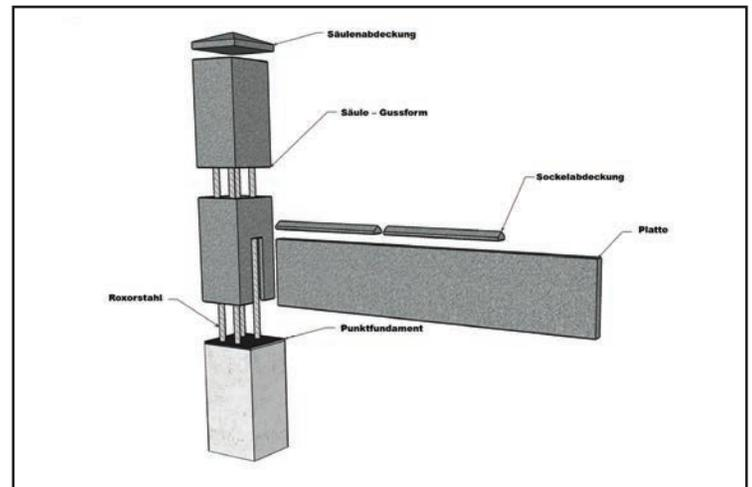
Straßeneinfriedung mit Betonplatte (auf Punktfundamente)
